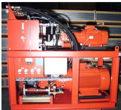
Separater Hydraulikantrieb mit zwei stufenlos verstellbaren Hydraulikpumpen
